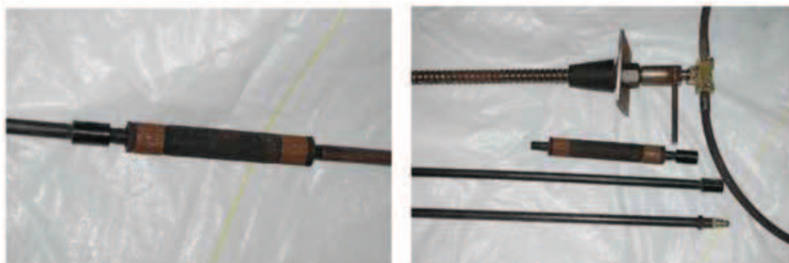
Rys. 4. Głowica uszczelniająca jednorazowego użytku oraz kompletna kotew samowiertna-iniekcyjna Fig. 4. Disposable sealing head and complete self-drilling injection bolt
