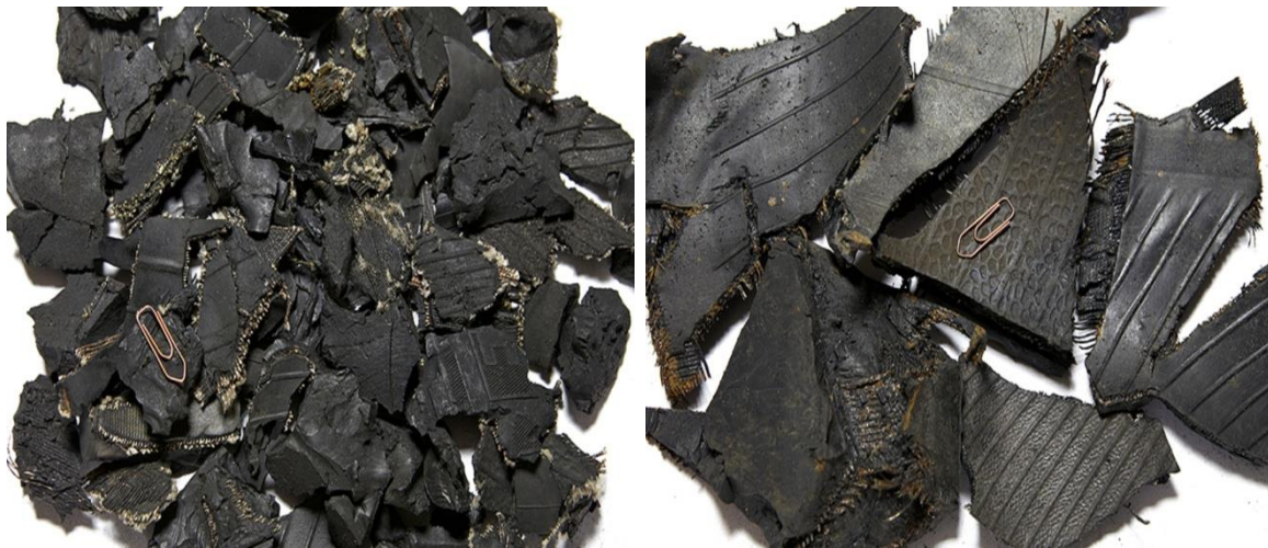
Rys. 1. Formy rozdrobnionych opon przydatne do wypełnienia nasypów; a. czipsy, b. strzępy
