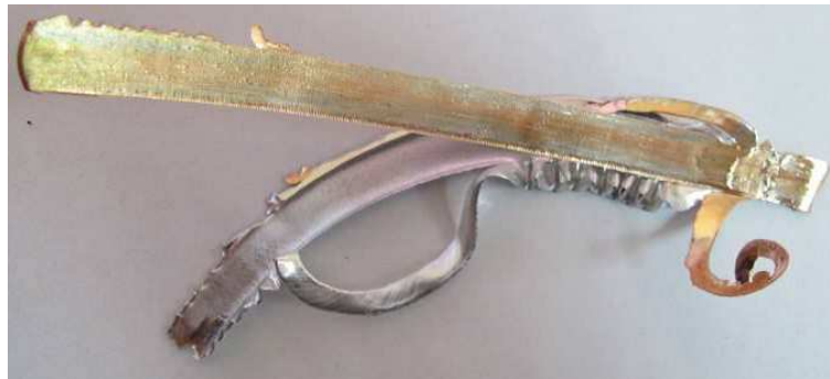
Rys. 7. Próbką nie spojona wykonana przy parametrach: 8 obr/min, 126 kN – widok od strony tarczy
