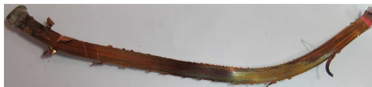
Rys. 15. Próbką spójona w układzie miedź M1E aluminium 6063 – widok od strony matrycy
