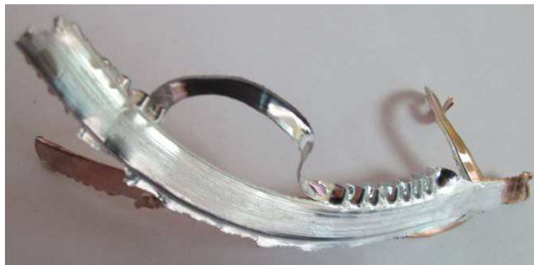
Rys. 8. Próbką nie spojona wykonana przy parametrach: 8 obr/min, 126 kN – widok od strony matrycy
