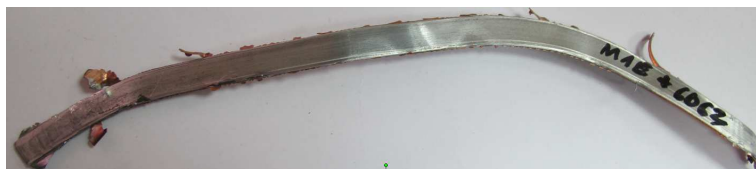
Rys. 14. Próbką spójona w układzie miedź M1E aluminium 6063 – widok od strony matrycy
