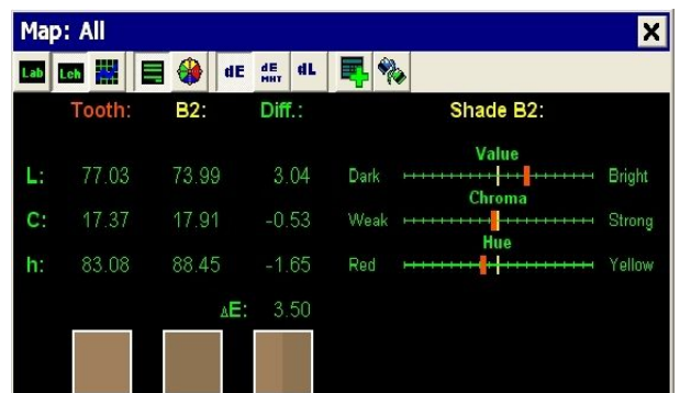
Rys.4. Diagram koloru korony zębowej licowanej światłoutwardzalnym kompozytem (próbka po 30-dniowej ekspozycji w sztucznej ślinie wraz z dodatkiem glukozy)
