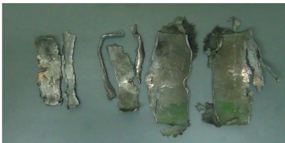
Fot. 4. Pozostałości układu odniesienia uzyskane w wyniku działania SCJ
