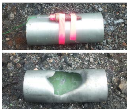
Fot.5. Układ badawczy służący do wyznaczania średnicy krytycznej ładunków
