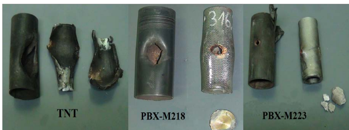
Fot. 3. Przykładowe skutki działania strumienia kumulacyjnego (SCJ), stanowiące podstawę do oceny wrażliwości badanych kompozycji/ładunków na działanie SCJ
