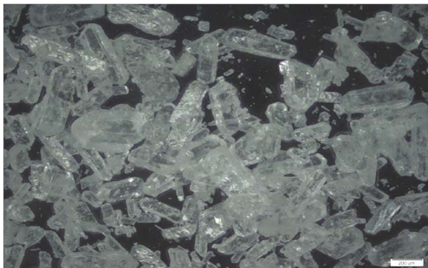
Fot.1. Kryształy PETN wykorzystywanego do otrzymywania kompozycji
