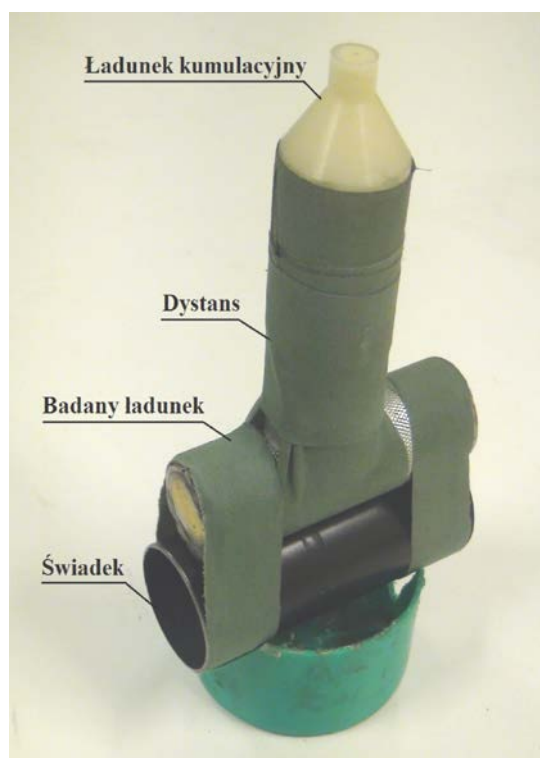
Fot. 2. Układ badawczy do oceny wrażliwości kompozycji na działanie strumienia kumulacyjnego (SCJ)
