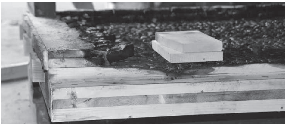
Rys. 3. Wygląd elementu Holz100 o grubości 20 cm po 1 godzinie w płomieniu 1000°C [11]
