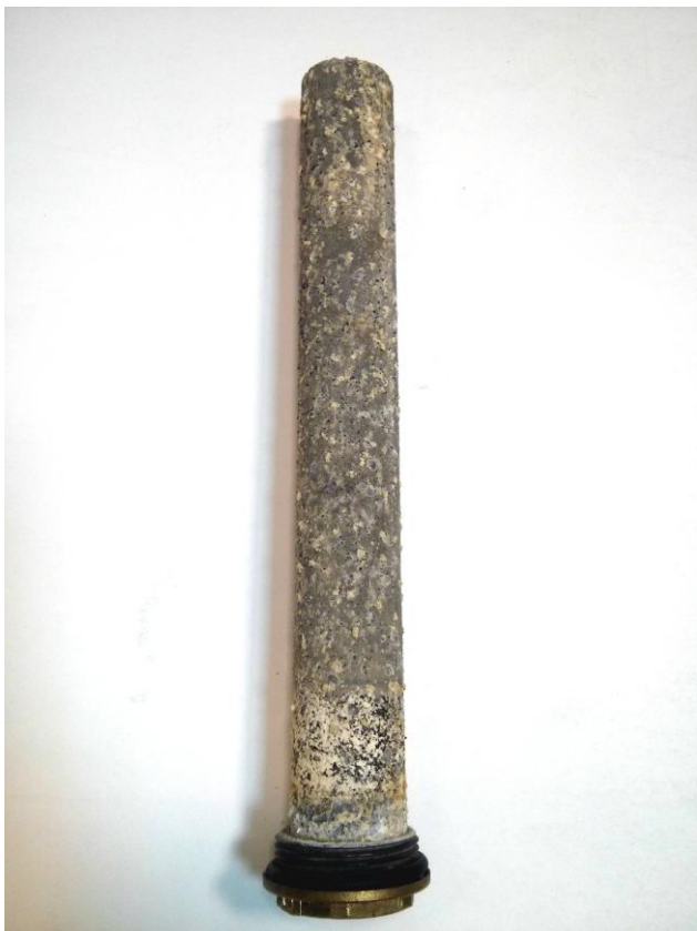
Rys. 2 Anoda magnezowa pokryta kamieniem kotłowym [opracowanie własne]
