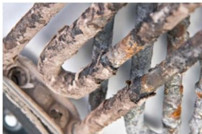
Rys. 1 Kamień kotłowy na powierzchni grzałki elektrycznej [1]
