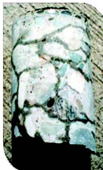
Fot. 5. Dobrze widoczne spękania w trakcie wysychania betonu po wcześniejszym zwilżeniu [2]
