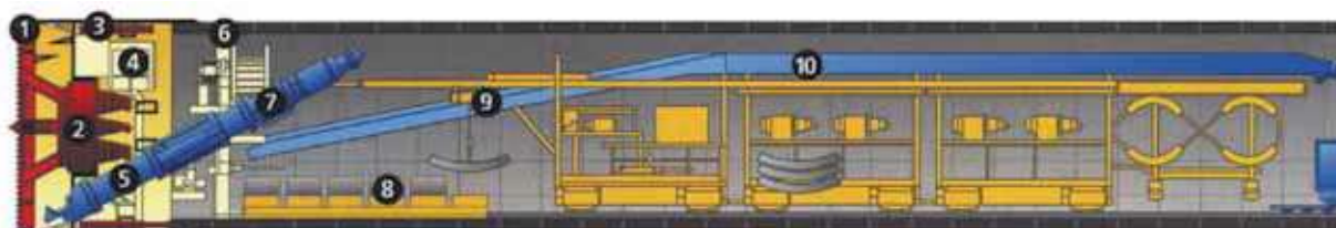
Rys. 2. Przekrój tarczy TBMs EPB [3]: 1 – głowica urabiająca, 2 – zespół napędowy, 3 – silowniki główne, 4 – śluza powietrzna, 5 – przenośnik ślimakowy, 6 – układarka, 7 – wysyp przenośnika ślimakowego, 8 – podajnik segmentów, 9 – dźwig do przenoszenia segmentów, 10 – przenośnik taśmowy
