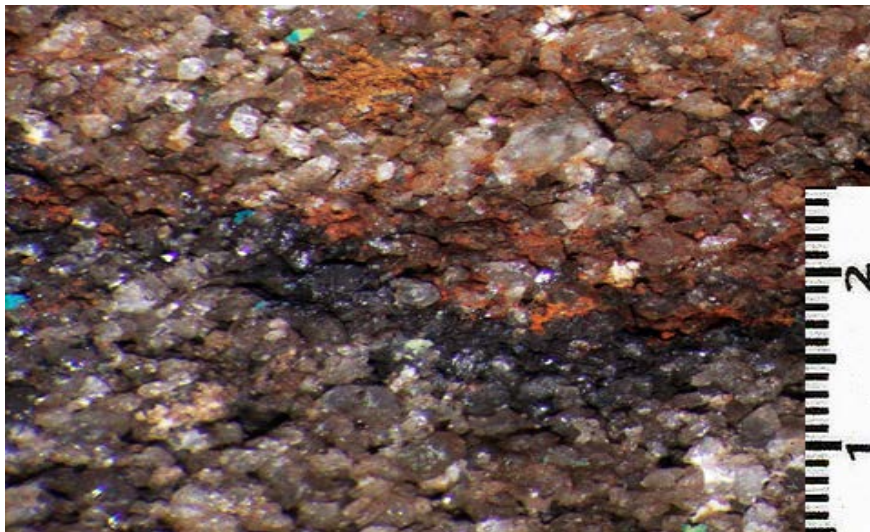
Fot. 3 Próbka 3. Fotografia kontaktu piaskowca nie zwietrzałego (dolna część – szara) ze strefa utleniona i zwietrzałą ( górna część brązowo-czerwona). Pomiędzy strefami widoczna ciemna koncentracja związków żelaza.
