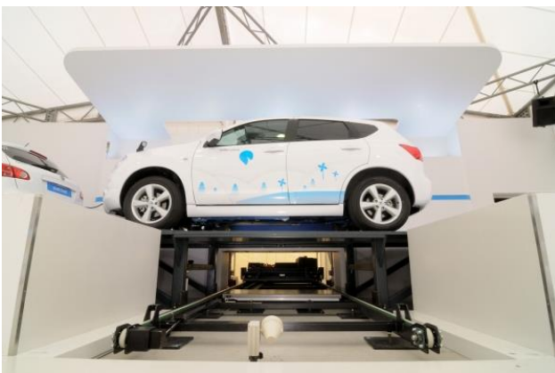
Rys. 7. Stacja wymiany baterii Better Place Źródło: http://samochodyelektryczne.org/galerie/stacje_wymiany_akumulatorow_better_place/stacje_wymiany_akumulatorow_better_place_1.htm
