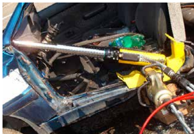
Ryc. 21. Przykładowe zastosowanie cylindrów rozpierających [9]
