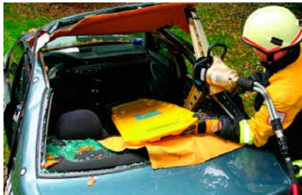
Ryc. 19. Przykładowe zastosowanie rozpieracza ramieniowego [9]
