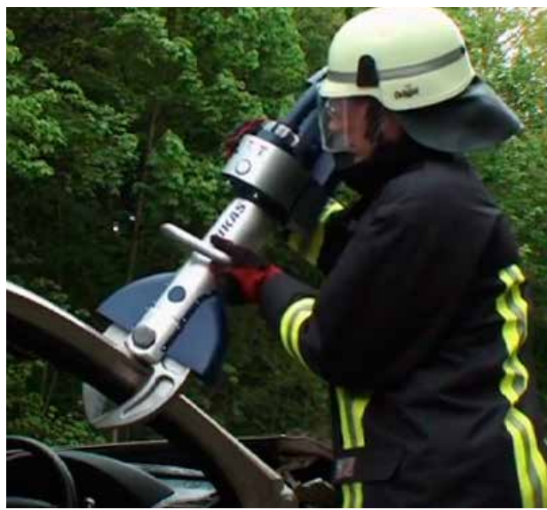
Ryc. 20. Przykładowe zastosowanie nożyc hydraulicznych [5]
