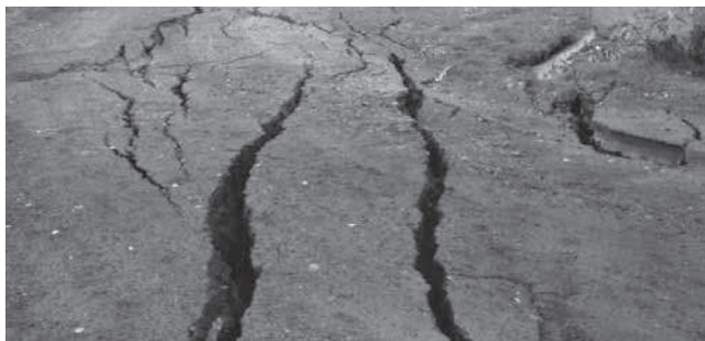
Rys. 3. Szczeliny zewnętrzne na granicy leja zapadliskowego wywołanego katastrofą górniczą rury szybu V KWK „Szczygłowice” w 2008 r.
