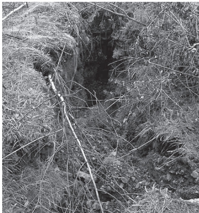
Rys. 5. Rozwarta szczelina w gruncie wewnątrz leja zapadliskowego, powstałego w wyniku katastrofy górniczej rury szybu V KWK „Szczygłowice” w 2008 r.
