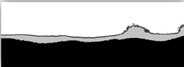
Rys. 9. Widok strefy przetopu złącza spawanego
