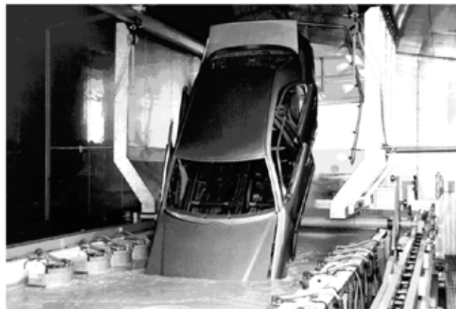
Rys. 8. Zanurzanie karoserii w kąpeli (BASF Coatings). Z brzegu: Przeciwelektrody (anody) zamontowane w komorach do dializy
