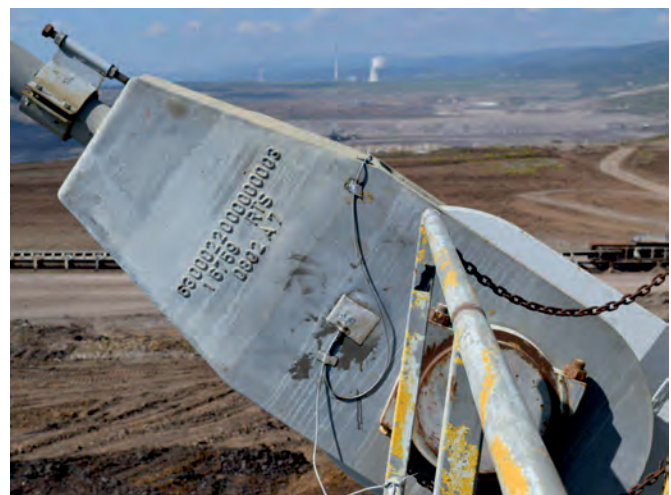
Fig. 3. Situation of tensiometric sensors R1- R4 Rys. 3. Lokalizacja czujników tensometrycznych R1-R4
