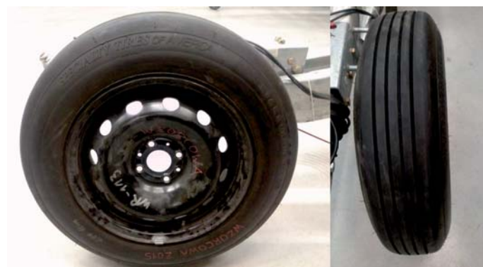
Fot. 10. Zestaw pomiarowy SRT-3 i opona P.I.A.R.C (fot. A. Polecki)
