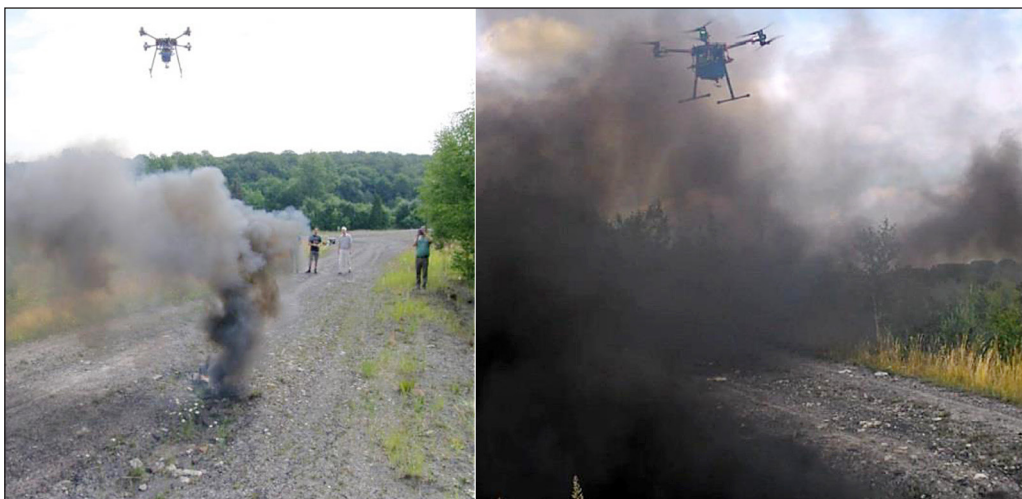
Rys. 2. Próby poligonowe czujnika z wykorzystaniem świec dymnych jako źródła dymu
