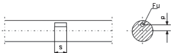
Rys. 5. Parametry wpływające na impuls indukowany w cewce [3]
