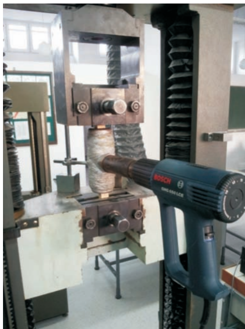
Rys. 4. Schemat układu badawczego do oznaczenia wytrzymałości na rozciąganie w podwyższonej temperaturze
