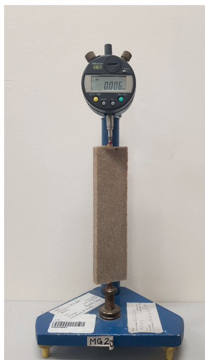
Fot. 4. Aparat Graf-Kaufmana do oznaczania skurczu zapraw do spoinowania
