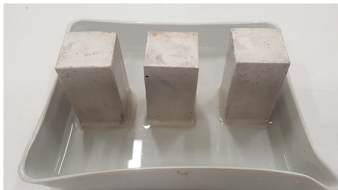
Fot. 5. Metoda oznaczania absorpcji wody zapraw do spoinowania.
