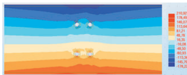
Rys. 2. Fragment mapy rozkładu naprężeń normalnych w obrębie otworów montażowych w środniku analizowanego dwuteownika dla modelu powłokowego [2]
