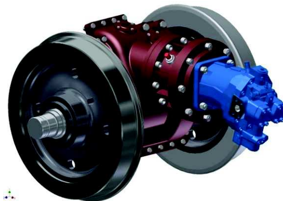
Rys. 11. Zestaw kołowy z zabudowanym silnikiem hydraulicznym [9]
