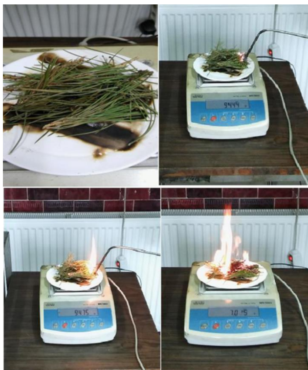
Rys. 5. Widok zapłonu i procesu spalania próbki igliwia sosnowego
