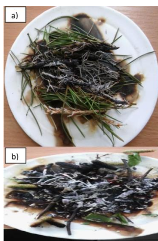
Rys. 6. Widok pozostałości po spalaniu próbki: a) igliwie sosnowe, b) liście brzozy
