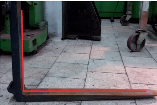
Fig. 3. Testing deformations of the fork tip core Rys. 3. Sprawdzenie odkształcenia trzonu kła widły
