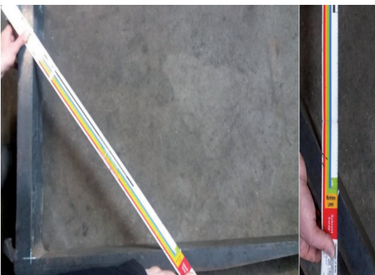
Fig. 4. Fork dilation angle inspection Rys. 4. Kontrola kąta rozwarcia widel
