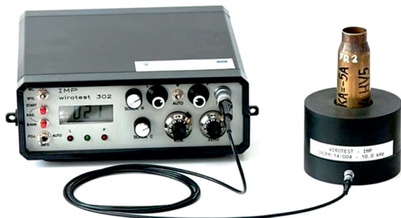
Rys. 3. Badanie łusek mosiężnych – Wirotest 302 z sondą przelotową
