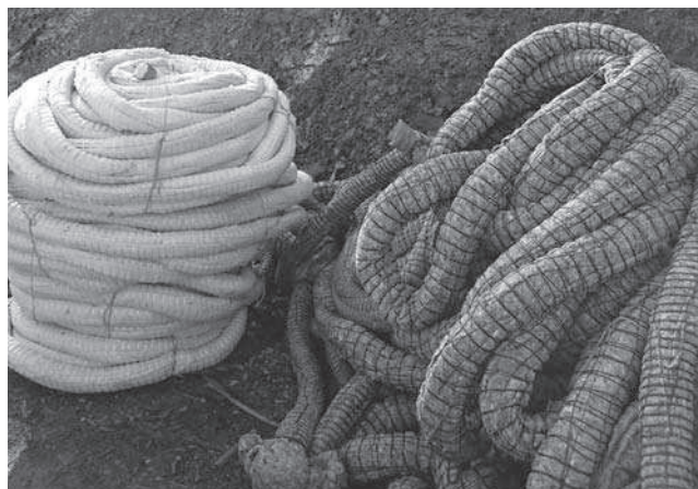
Rys. 4. Sznury Kemafil® wykorzystane do zabezpieczenia przeciwerozyjnego skarpy
