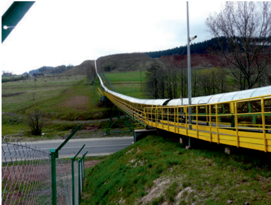
Rys. 1. Przenośnik dalekiego zasięgu transportujący kruszywo z kopalni „Świerki” do bocznic kolejowej w Bartnicy (fot. P. Kulinowski) Fig. 1. The long distance belt conveyor transporting aggregates from the „Świerki” quarry to the Bartnica railway depot (photo: P. Kulinowski)
