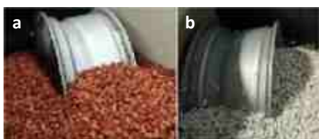
Rys. 3. Fazy procesu obróbki wygładzającej obręcze: a) gratowanie, b) polerowanie
