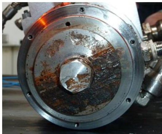
Rys. 8. Tarcza oporowa łożyska z zanieczyszczeniem powodującym niewyważenie wirnika
