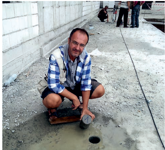
Rys. 3. Odwiert rdzeniowy walcowy, w głębi: pobieranie następnej próbki. Fig. 3. The core cylindrical, at the back: taking sample of the next specimen.
