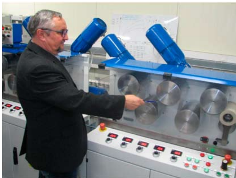
Fot. 4. Urządzenie do jednoosiowego orientowania folii typu „cast” prezentuje dr inż. Zbigniew Frąszczak
