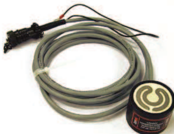
Rys. 3. Czujnik korozymetryczny rezystancyjny typu ER-10/0,8-FC
