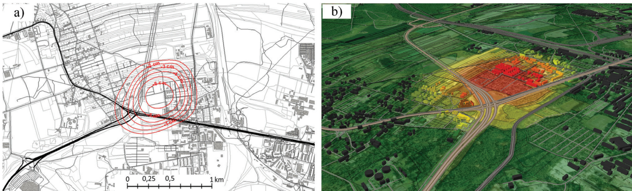
Rys. 2. Zdjęcie satelitarne – obraz deformacji powierzchni wg [8]
