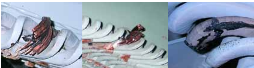
Rys. 1. Zwarcia zwojowe w obrębie główek, uszkodzenia dla różnych silników
