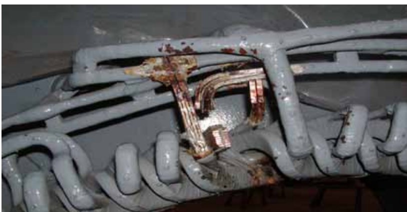
Rys. 2. Deformacja czoł cewek, zwarcia zwojowe, rozerwanie wiązań
