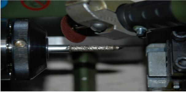
Рис. 4. Игла распылителя с нанесенным на нерабочую поверхность катализатором и турбулизационными точечными каналами
