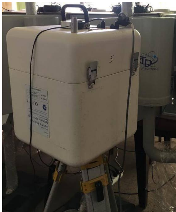
Fot. 1. Komora jonizacyjna RSS-131 na tle jednej z sond TDSG3 podczas pomiarów porównawczych
