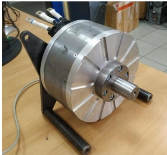
Rys. 5. Silnik z 20 biegunowy z magnesami trwałymi serii LEMOK
