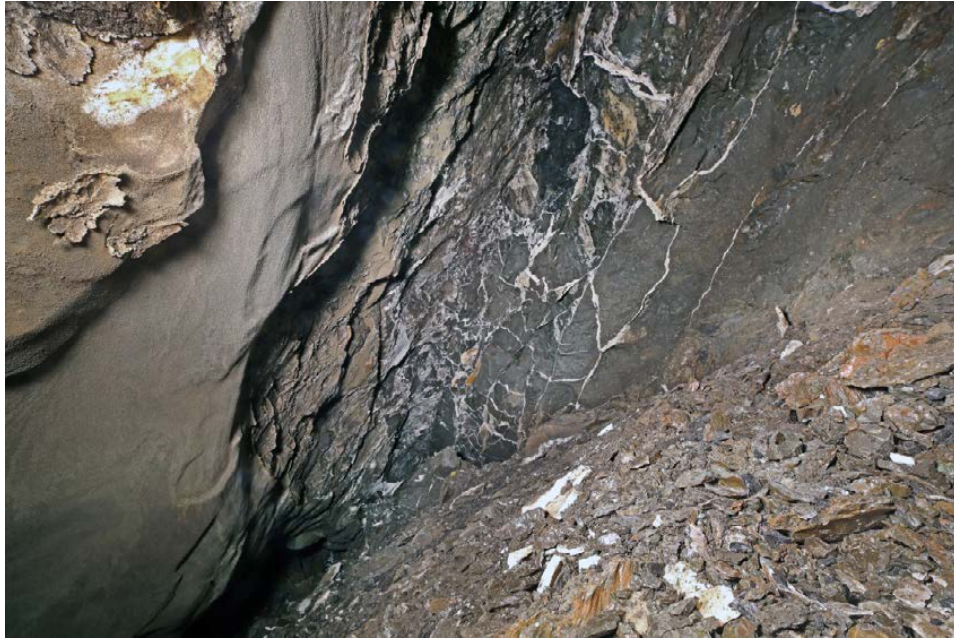
Ryc. 11. Skały odsłaniające się w kawernie wyługowanej wodami z wycieku w poprzeczni Kloski – zapiaszczone sole spizowe, zubry z siecią spękań wypełnionych solą włóknistą, flisz karpacki. Stan na luty 2017.
