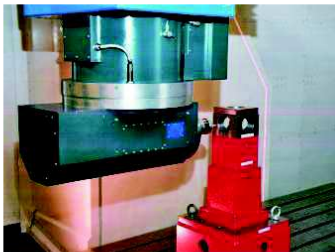
Rys. 3. Pozycjonowanie obrabiarki z zastosowaniem specjalnego ustawiaika
