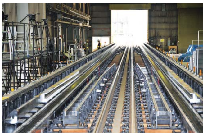
Stanowisko zmiany rozstawu kół na stacji Tsuruga; perspektywa 1435 mm → 1067 mm. Fot. © JR West
