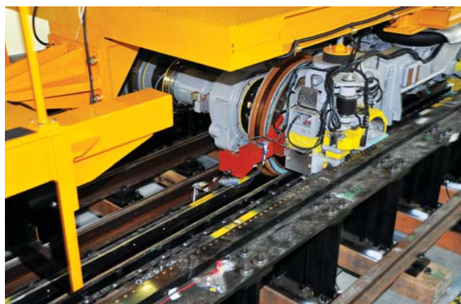
Wózek pociągu FGT podczas operacji zmiany rozstawu kół na stanowisku przestawczym. Fot. © JR West
