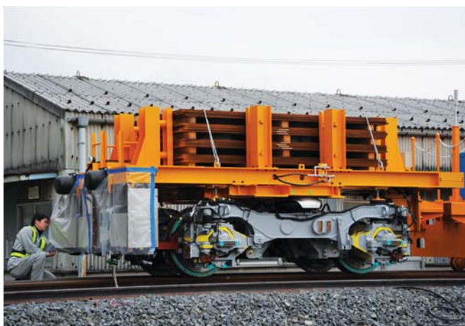
Wózek pociągu FGT na torze o rozstawie 1067 mm. Fot. © JR West
