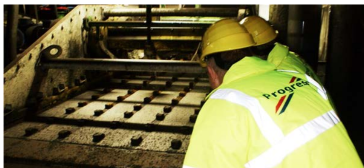
Rys.5. Kontrola efektywności pokładu sit szczelinowych Pro-SLOT® zabudowanych w systemie Pro-CLIN produkcji Progress Eco
