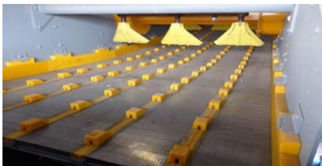
Rys. 4. Sita szczelinowe zgrzewane zabudowane w systemie PRO-CLIN na przesiewaczu PWP1-2Z-2,4x6 firmy Progress Eco ( www.progress-technika.pl )
