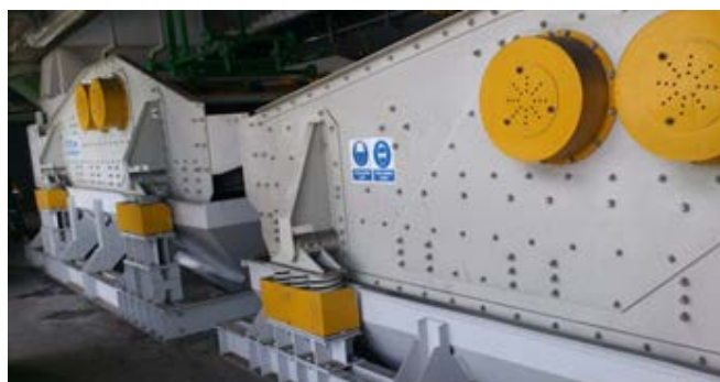
Fot. 3. Odbiór węgla na przesiewacze odwadniający i sortujący po wzbogacalniku DISA, przesiewacze firmy Progress Eco ( www.progress-technika.pl )
