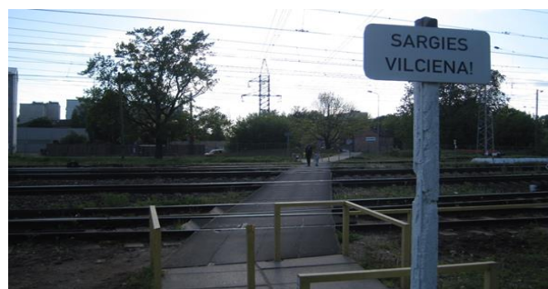
Rys. 12. Łotwa – przejście przez tory bez oznaczenia krzyżem św. Andrzeja, wyposażone jedynie w znak informacyjny z napisem „Strzeż się pociągu” [opracowanie własne]
