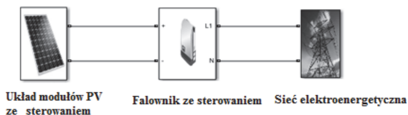
Rys. 2. Model instalacji PV
