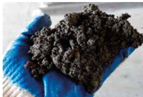
Rys. 3. Mieszanka betonu wałowanego przed zagęszczeniem [1]
