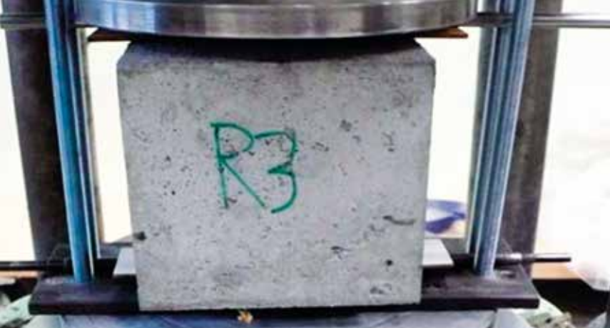
Powyżej: rys. 6. Przebieg badania wytrzymałości na rozciąganie przy rozłupywaniu [1]
