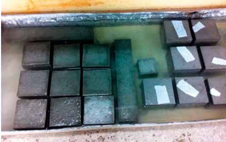
Rys. 4. Próbkę z betonu wałowanego podczas dojrzewania [1]
