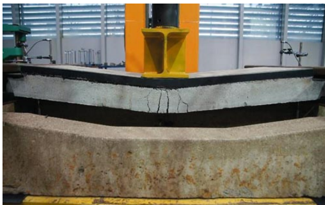
Rys. 5. Widok zniszczonej płyty wewnętrznej na zginanie przy obciążeniu siłą P_n = 187 kN
