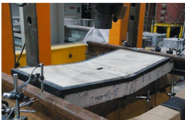
Rys. 6. Widok od góry złamanej podczas zginania strefy betonu płyty wewnętrznej
