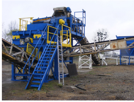
Fig. 5. Crusher & classification unit [photo IMBiGS] Rys. 5. Moduł krusząco-klasyfikujący [fot. IMBiGS]
