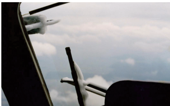
Rys. 27. Próby w warunkach oblodzenia. W górnej części fotografii wskaźnik oblodzenia z lewej strony kabiny pilotów. [5]
