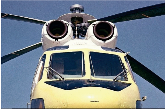
Rys. 10. Masa 100 kg na wale wirnika nośnego obniżająca częstotliwość drgań własnych pylonu. [6]
