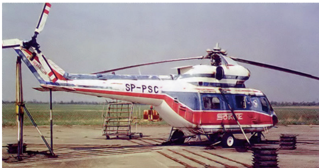
Rys. 6. Stoisko otwarte do prób naziemnych – egzemplarz prototypu nr 03 wycofanego po próbach w locie. [6]
