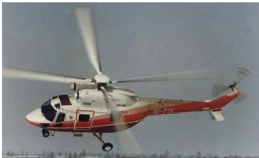
Rys. 14. Śmigłowiec W-3A z deflektorem wkomponowanym w osłonę przekładni głównej. [6]
