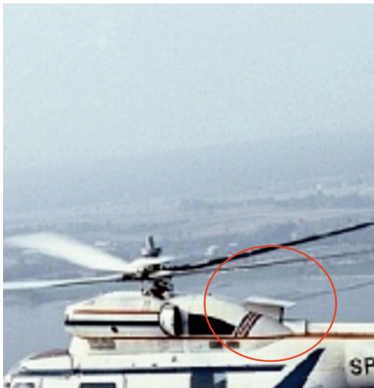
Rys. 13. Deflektor dla uporządkowania strug spływających z wirnika głównego. [6]
