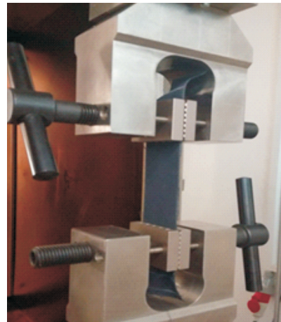
Rys. 4. Zrywarka LabTest 6100SP1-2-2300 oraz szczęki do mocowania próbek tkaniny
