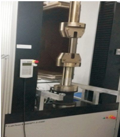
Rys. 4. Zrywarka LabTest 6100SP1-2-2300 oraz szczęki do mocowania próbek tkaniny
