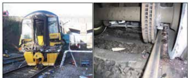
Rys. 4. Wykołenie w Barrow, uszkodzony przód pociągu (po lewej); prowadzenie zapewnione przez tarcze hamulcowe (po prawej) [68]
