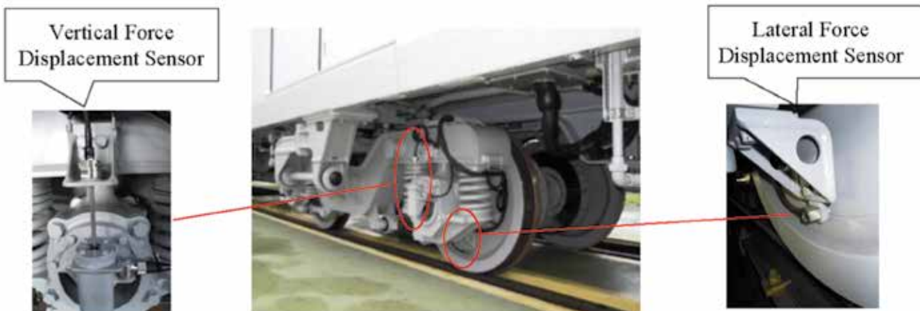
Rys. 7. Wózek pojazdu wyposażony w system monitorowania sił poziomych i pionowych [64]
