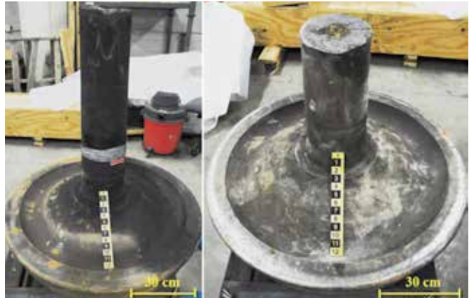
Rys. 2. Pęknięte zestawy kołowe, w stanie po zdarzeniu [67]
